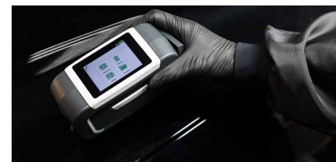
En högupplöst RGB-kamera analyserar kulörton, glitter och effekt.
