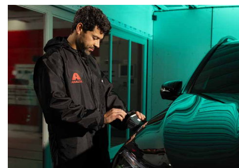
Irus Scan är den första spektrofotometern med inbyggd glansmätning.
